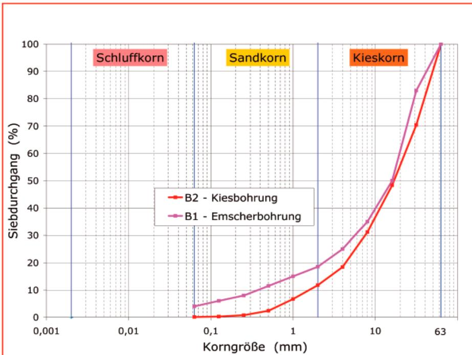
Abb. 1: Kornverteilungskurven lt. Baugrundgutachten
