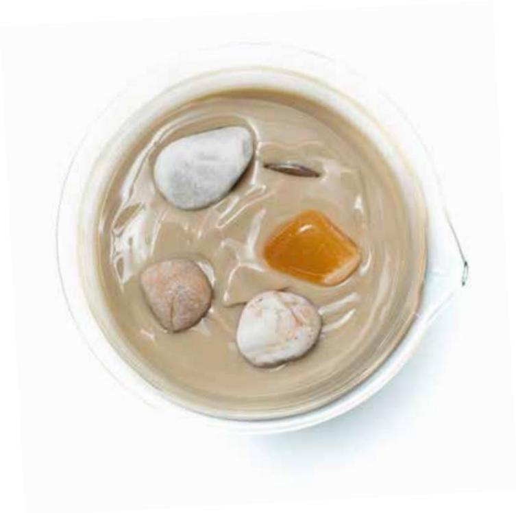
!!! Durch die stark scherverflüssigende Rheologie sind unsere Spezialspülungen für Kies trotz außerordentlich hoher Tragfähigkeit noch gut pumpbar. Der geringe dynamische Druck im Bohrkanal reduziert bei diesen Spülungen deutlich das Risiko von Ausbläsern.
